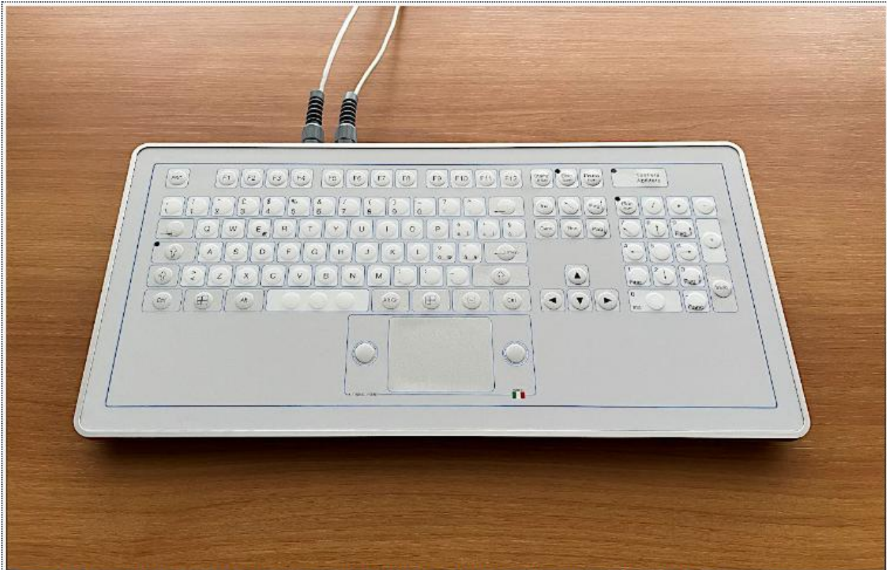
KT-105-TM-04 tastiera 105 tasti da tavolo con tastierino numerico keypad e mouse touchpad capacitivo
